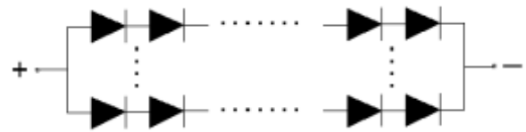
等效电路（3 并 12 串） Equivalent-circuit (3 parallels 12 series)
